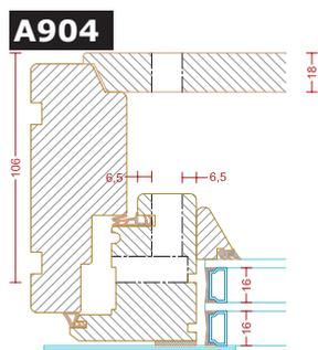
(Brüstungselement mit glatter Füllung innen (wird lose mitgeliefert) und durchgefärbtes Glas außen)
